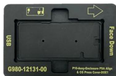
Plaque de presse adhésive sensible à la pression pour boîtier Pixel 7, avec alignement de la vitre avant
