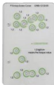
Plaque de positionnement des vis pour Pixel 7
